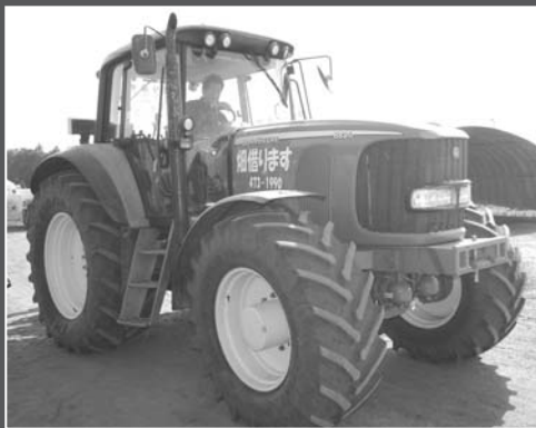
燃費の良い最新の大型機械、ジョンディア6820。135馬力。
